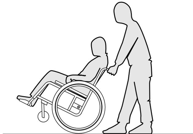
Um den Benutzer den Kippunkt zu zeigen, kann der Rollstuhl von einer Begleitperson mithilfe einer Schiebestange nach hinten gekippt werden.
